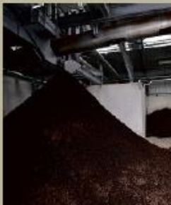
ARRIVAGE. Les matières sont issues de l'agriculture, de l'agro-industrie, de l'industrie agro-alimentaire et des collectivités. Elles servent à la production de biométhane et d'un digestat destiné à l'épandage.
